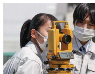
建物を正確に測るトランシット測量
