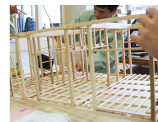
平屋建て住宅の軸組模型製作
