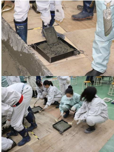
平板の型枠にコンクリートを入れ締めめます。
