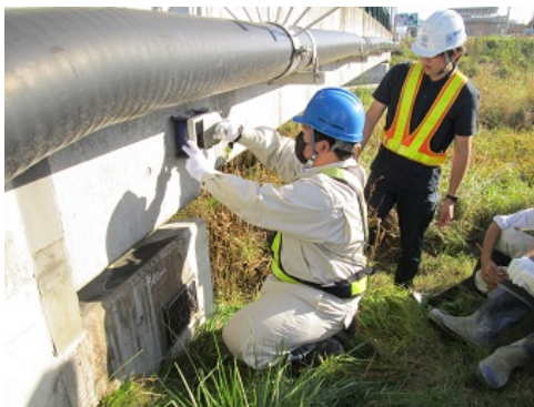
コンクリート内部探査を用いた検査を行っています。コンクリート内部にある鉄筋などの位置を正確に知ることができます。
