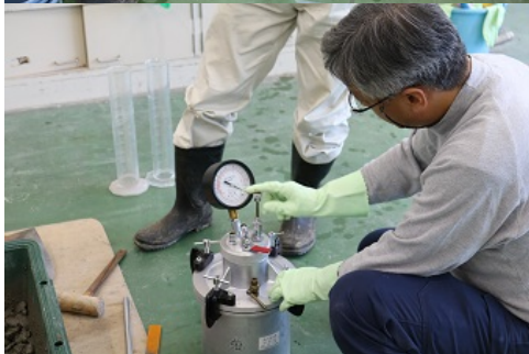
次に空気量の圧力による試験です。コンクリートの空気量を測定します。スランプ試験同様に現場での品質管理に用いられ、配合の適否を判定する重要な値です。
