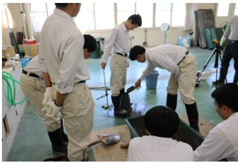
スランプコーンに三層に分けてコンクリートを詰め各層25回突きます。
