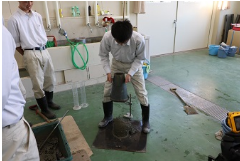
スランプ測定器の先端部をスランプコーンの中心軸に合わせ鉛直に引き上げます。
