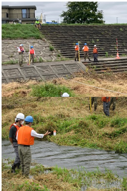
既定の水深にて流速計で観測を行います。
