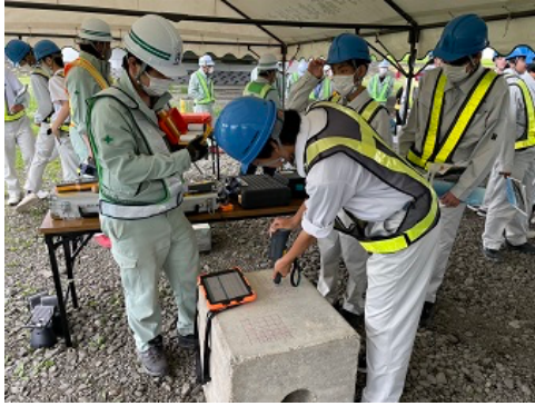
シュミットハンマーによるコンクリートの強度測定。
