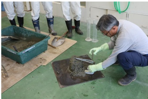
下がりか何cmか0.5cm単位で測定します。 この試験により求まるスランプ値は、フレッシュコンクリートの変形または流動に対する抵抗性であるコンシステンシーを判定し、現場での品質管理に用いられるもので、配合の適否を判定するための重要な値です。
