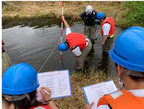
低水流量観測の様子です。水深を計測しています。
