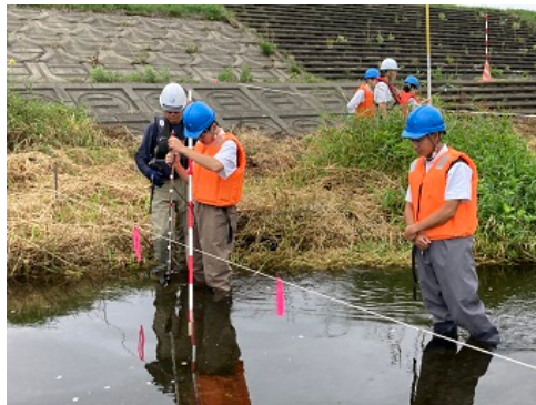
既定の水深にて流速計で観測を行います。
