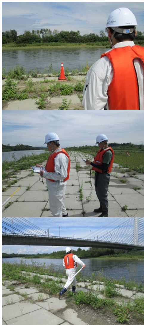
株式会社北開水工コンサルタント様での実習の様子です。高水量流量観測を行っています。
