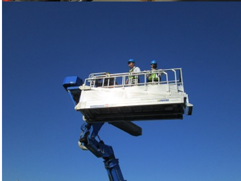
橋梁点検車両は橋梁下部の様々な点検を行うことができます。
