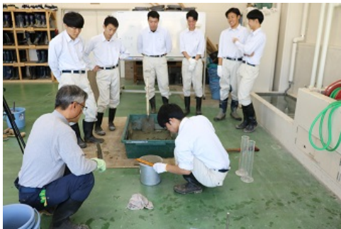
下がりか何cmか0.5cm単位で測定します。 この試験により求まるスランプ値は、フレッシュコンクリートの変形または流動に対する抵抗性であるコンシステンシーを判定し、現場での品質管理に用いられるもので、配合の適否を判定するための重要な値です。
