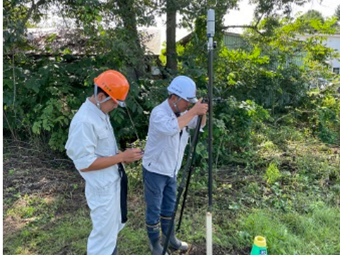
西岡建設株式会社様の実習の様子です。GNSS測量器を用いて基準点を元に、データコレクタに測点の値を入力しているところです。
