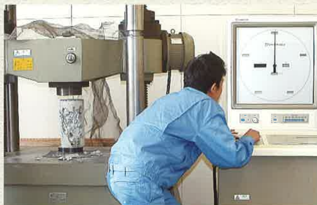
コンクリートの圧縮試験
